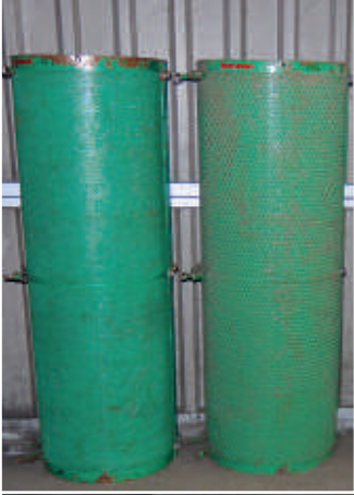
■ In den Siebtrommeln (links) wird Saatgut gereinigt. Über- und Unterkorn sowie anderes nicht verkaufbares Saatkorn wird als Brennstoff in einem Silo (unten) zwischengelagert.
